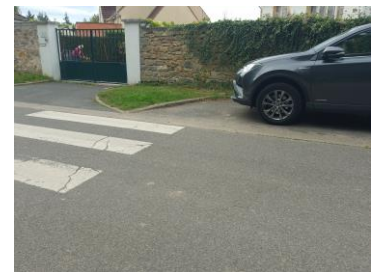
Rue de La Garenne / Rue du Bois d'Azier : absence de zone libre de stationnement avant le passage piéton
